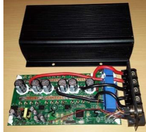
Fig:2 Motor Control
